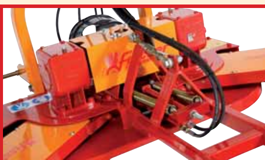
Hydraulischer Schwenkarmeinzug beidseitig mit einem Zylinder
