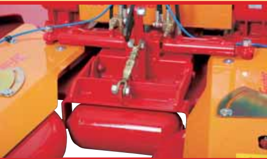
Höhenverstellbare Laufwalze mit Gewindespindel
